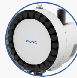
24 расположение магазина инструментов дискового типа
