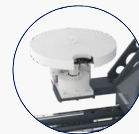
магазин инструментов зонтичного типа на 12 мест
