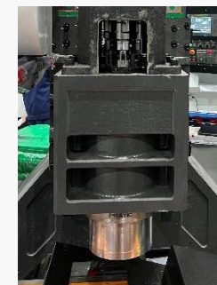
Импортированный высокоскоростной шпиндель с прямым приводом
